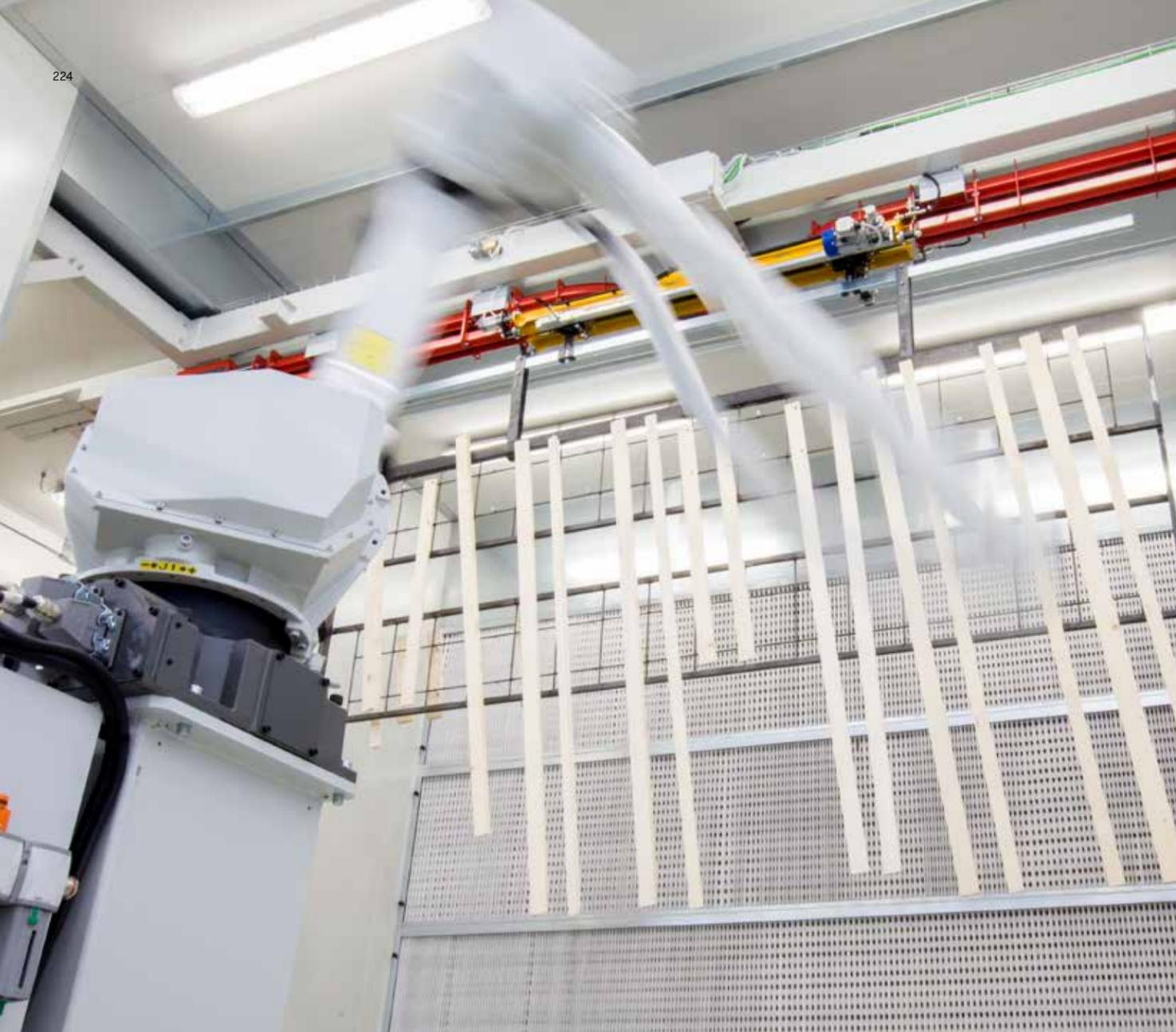
Gefertigt mit handwerklicher Sorgfalt und maschineller Präzision: Lackierung der Holzleisten durch Roboter in unserem Holzwerk in Oppeano (Verona/Italien).
