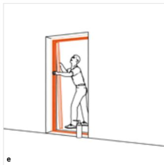
e Der alte Holz-Blendrahmen wird von außen verblendet.
