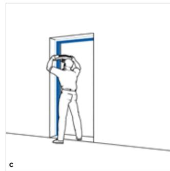
c Der alte Holz-Blendrahmen wird von Beschlägen befreit und zurückgeschnitten.
