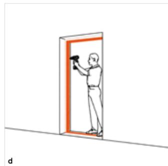
Nach Abschluss aller groben Arbeiten wird die Bautür entfernt und der neue Türrahmen mit der Montagezarge verschraubt.
