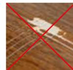
Herkömmliche Kunststoff-Oberflächen mit aufgeklebter Holzdekor-Folie lösen sich bei Beschädigung leicht ab.
