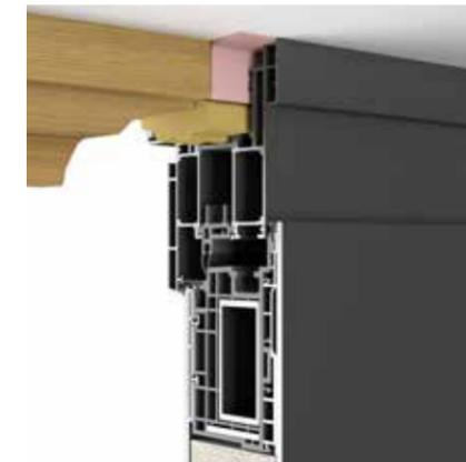
Austausch mit Einschubmontage auf bestehendem Aluminium- oder Kunststoffrahmen
