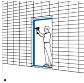
In der nassen Bauphase des Rohbaus wird eine wärmegeämmte Montagezarge in die Laibung eingebaut.
