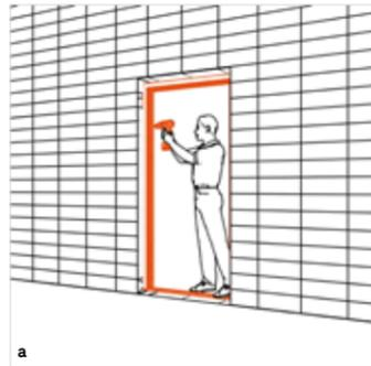
a In der nassen Bauphase des Rohbaus wird der neue Türrahmen in die Laibung eingebaut.
