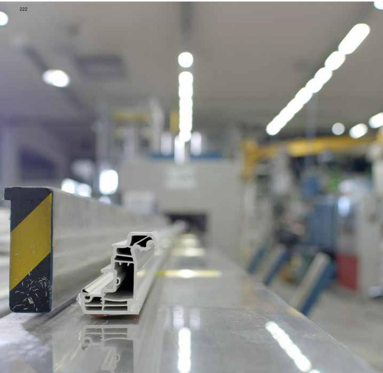
Funktioniert im Prinzip wie eine Nudelpresse: Extrusion eines Kunststoffprofils in unserem Werk in Kurtatsch (Südtirol/Italien).
